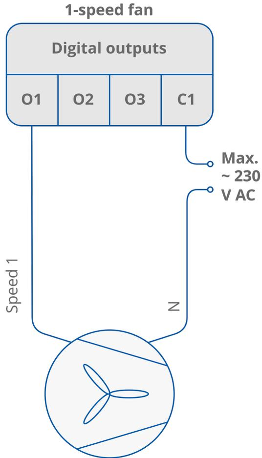
Figure 14. 1-speed fan connection
