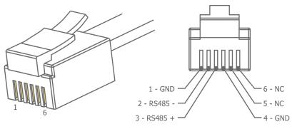
Figure 11. RJ12 pins
